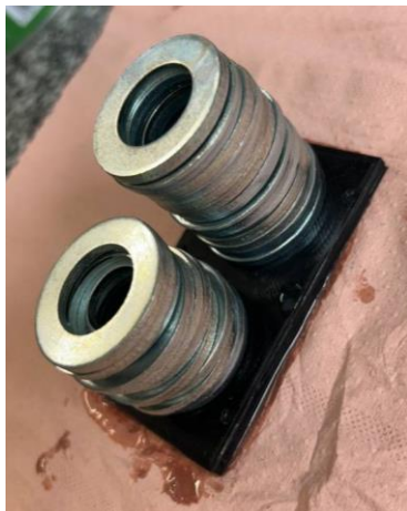
Figure 24 : Le moule rempli de silicone avec des poids placés dessus
