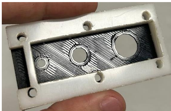
Figure 26 : Collage entre la pièce imprimée en 3D et le POM
