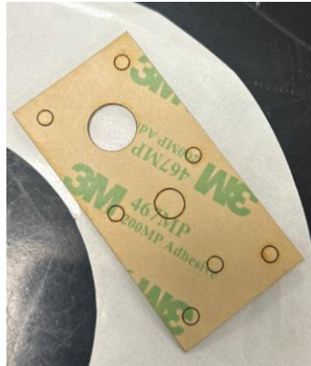
Figure 18 : Film plastique collé avec des adhésifs découpés au découpe laser
