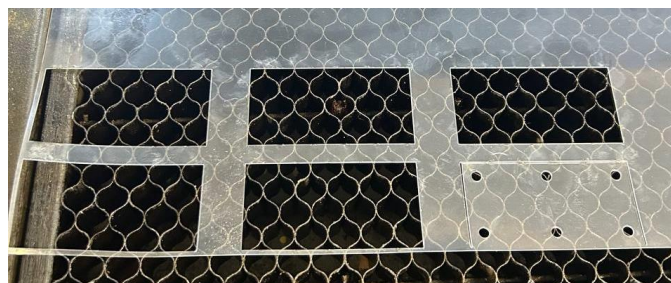
Figure 30 : Le film plastique dans la découpe laser
