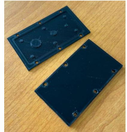
Figure 23 : Moule pour le silicone imprimé en 3D
